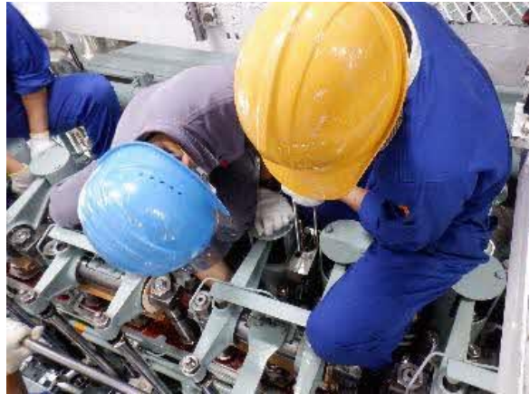
下の写真は燃料噴射弁を抜く瞬間
